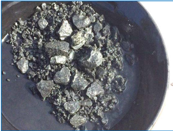
Sulphide lode 3.86g/t Au (BBRC0012; 193m-194m)
